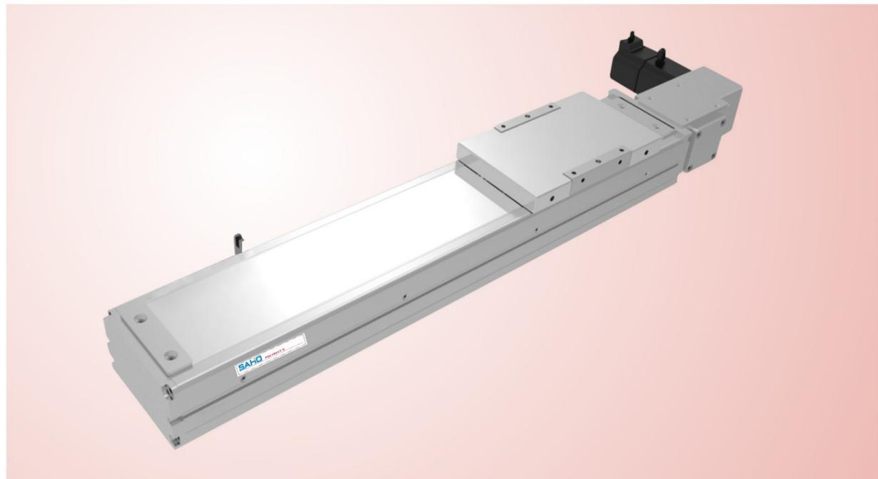
最大行程 2550 mm | 最高速度 1600mm/s | 马达容量 100W | 皮带宽度 15MM | 直线滑轨 20X15.5-1支
